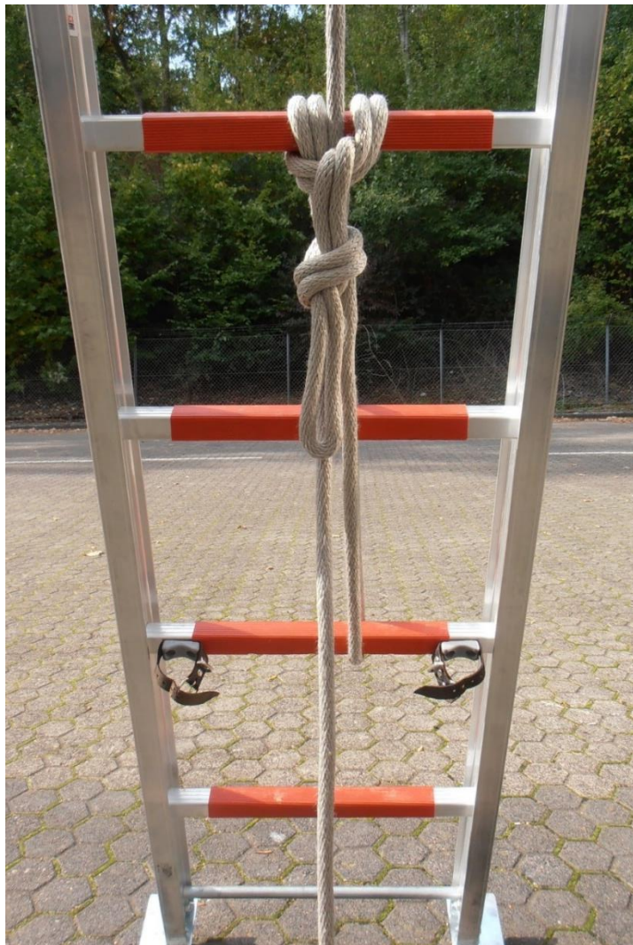
Abbildung 24: Sichern des Zugseils mit Mastwurf und Spierenstich
