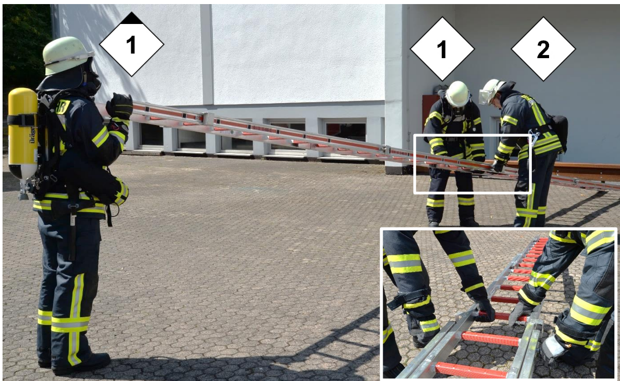
Abbildung 6: Zusammenstecken der Steckleiterteile
