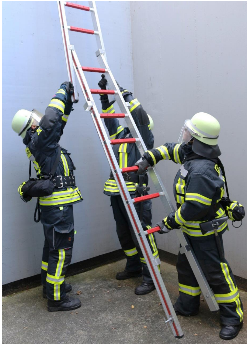
Abbildung 16: Einstecken eines Leiterteils am Leiterfuß
