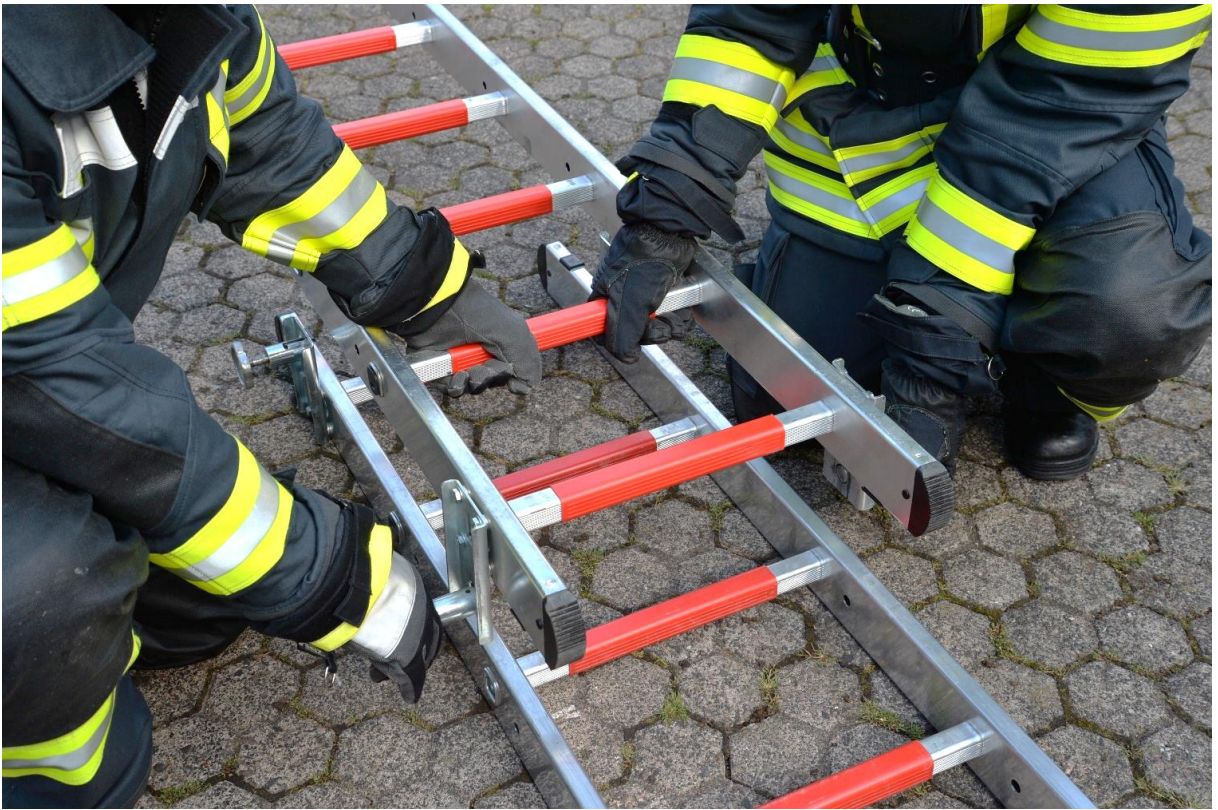
Abbildung 40: Ausrichten der Federbolzen
