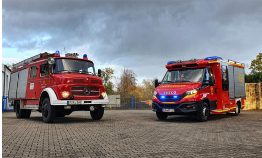
(16) Alt und neu: Tragkraftspritzenfahrzeug (im Bild rechts) mit Wassertank auch TSF-W abgekürzt (Foto: Feuerwehr Pirna)
