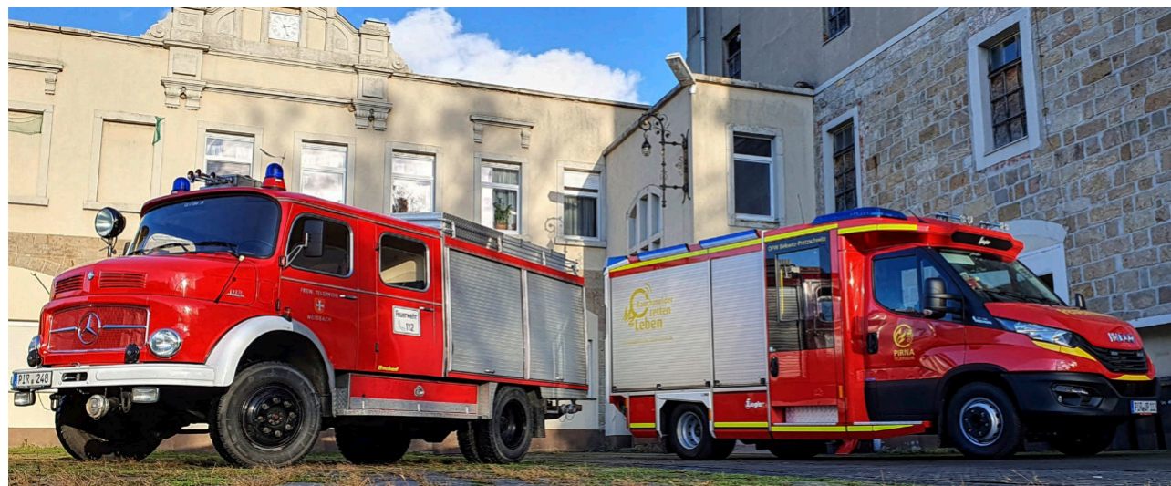
(1.2) V.l.: Tanklöschfahrzeug TLF 16/25 – Typ Mercedes Benz, Aufbau Bachert und das Tragkraftspritzenfahrzeug TSF-W – Typ Iveco, Aufbau Ziegler (Foto: Feuerwehr Pirna)
